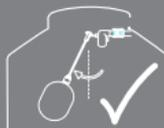
Posición correcta del flotador
