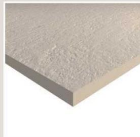
Superboard es una placa plana, mezcla de cemento, fibra celulosa, sílice, agua y agregados naturales y fabricada mediante un proceso de autoclave (alta presión, temperatura y humedad) que le brinda una gran estabilidad dimensional y alta resistencia. Las placas de cemento **Superboard ST** (Standard), son unas placas constructivas de borde recto que no reciben procesos adicionales para rectificar sus dimensiones y escuadra.
